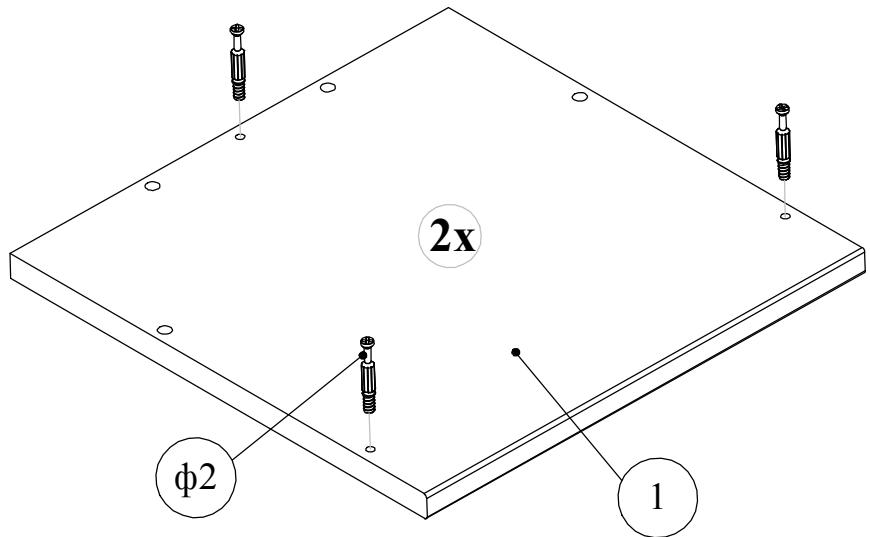
**2** При забивании навеса Hettich  $\phi 32$  необходимо положить деталь на горизонтальную поверхность, подложив под указанные отверстия обрезок древесины (ЛДСП, МДФ) и плотно прижав деталь к нему.
