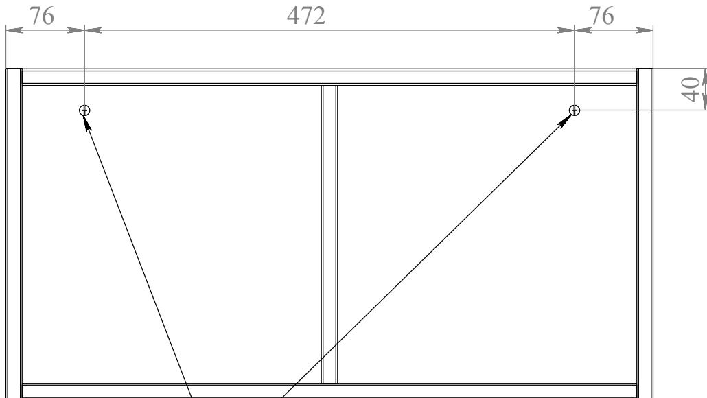
Регулировка положения полки
